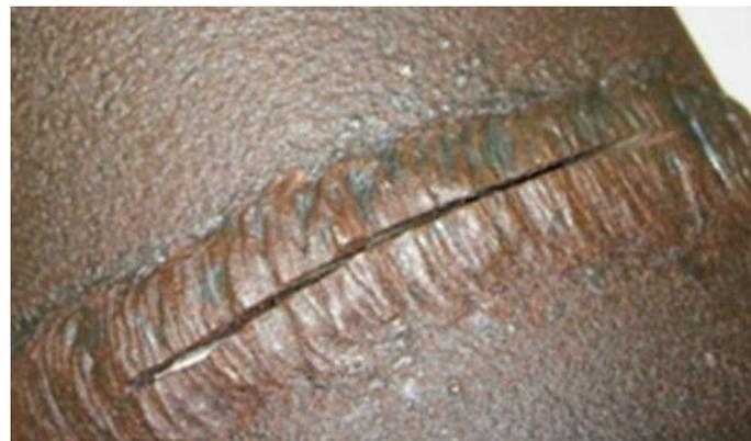
Рис. 15 Трещина
